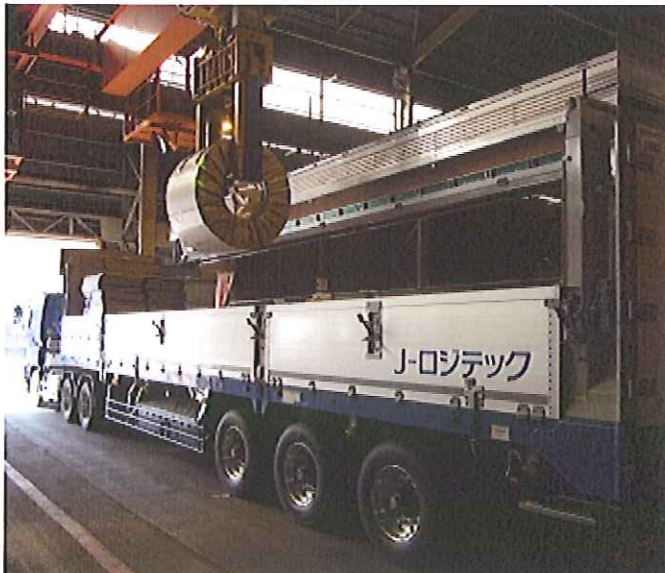
天井クレーン作業時 (鋼材荷役時)
