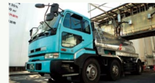
最大積載量11tの化学薬品用タンクローリー
