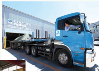
全長16m、最大積載量29tのトレーラー輸送
