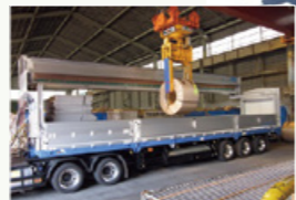
全長16m、最大積載量29tのトレーラー輸送
