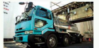
最大積載量11tの化学薬品用タンクローリー
