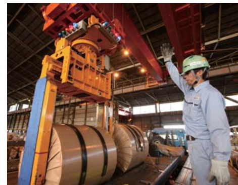
クレーンに指示を出して、コイルを積んでいく。玉掛けの資格は乗務員には必須。
