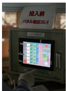
投入したスクラップの重量が表示される操作盤。「誤差0が出たときは最高の気分!」
