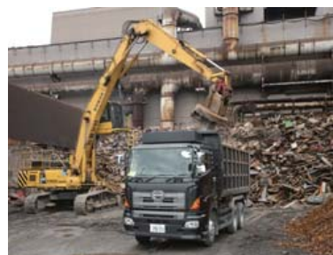
スクラップは種類ごとに分けて保管し、ダンプに載せてシャフト炉まで運ぶ。
