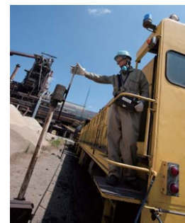
左右の分岐ポイントは車輛の 上から手で切り替えます。
