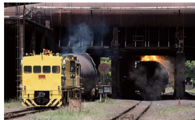
高炉でドロドロに溶けた鉄をトビード車に乗せて出発。 途中でノロ(不純物)を取り除き、製鋼工場に運びます。
