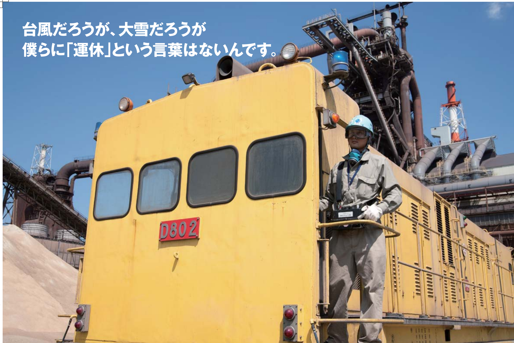
高炉でドロドロに溶けた鉄をトビード車に乗せて出発。 途中でノロ(不純物)を取り除き、製鋼工場に運びます。
