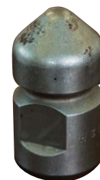
小口径の配管は、このようなノズルを先端につけたホースを通して洗浄する。ノズルは十数種類あり、配管径や用途によって使い分ける。
